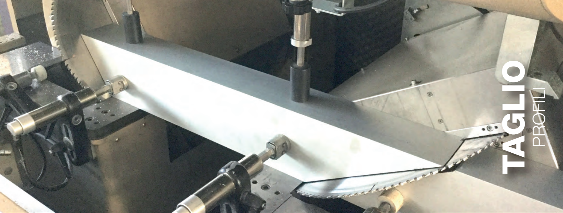
Troncatrici doppia lama Ø 500mm per taglio automatico di profili, gradazione elettronica delle teste e misuratore altezza profilo
